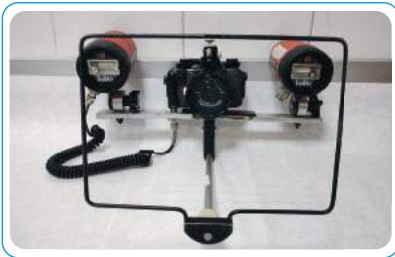
Figura. 5.26. Cámara fotográfica montada con lente close-up , soporte con delimitador de encuadre y flashes.
