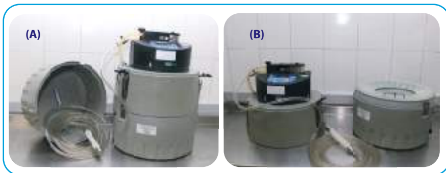
Figura 5.50. Tipo de muestreador automático utilizado en muestreos de agua y efluentes: (A) Visión general; (B) Equipo abierto, vista de los diferentes frascos de muestreo.
