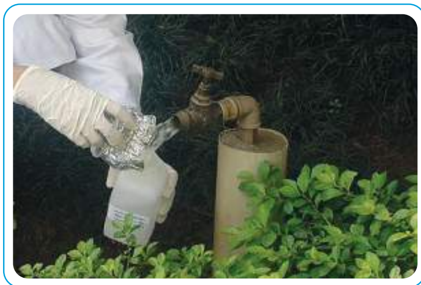
Figura 7.4. Toma de muestra en el grifo del jardín, después del hidrómetro.
