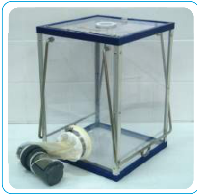
Figura 5.10. Trampa tipo Schindler-Patalas.
