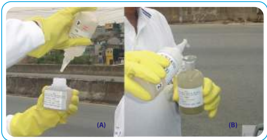
Figura 6.4. Procedimiento de conservación de muestras: (A) Adición de ácido nítrico 1+1 para preservar los metales; (B) Adición de acetato de zinc para la conservación del sulfuro.
