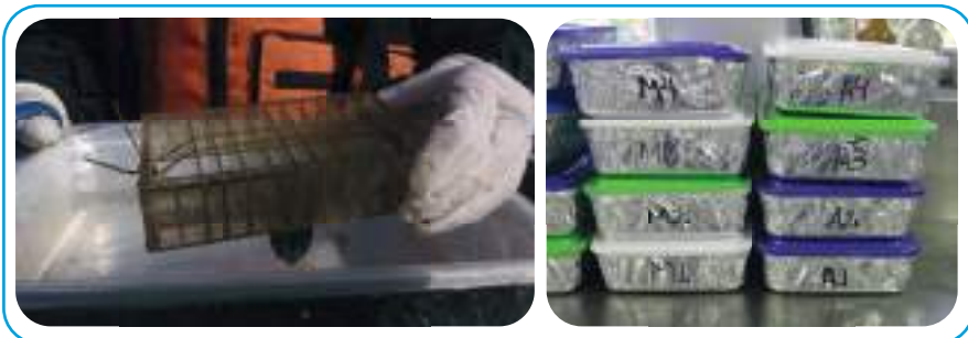
Figura 6.29. Recolección de muestras de perifiton: (A) Soporte que contiene láminas de vidrio colonizadas por el perifiton; (B) Ejemplo de cajas envueltas con papel aluminio y con tapa para proteger el material perifítico de la luz.
