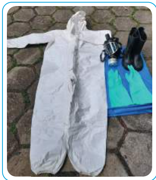
Figura 3.5. Equipo de protección individual para la toma de muestras en emergencias químicas.
