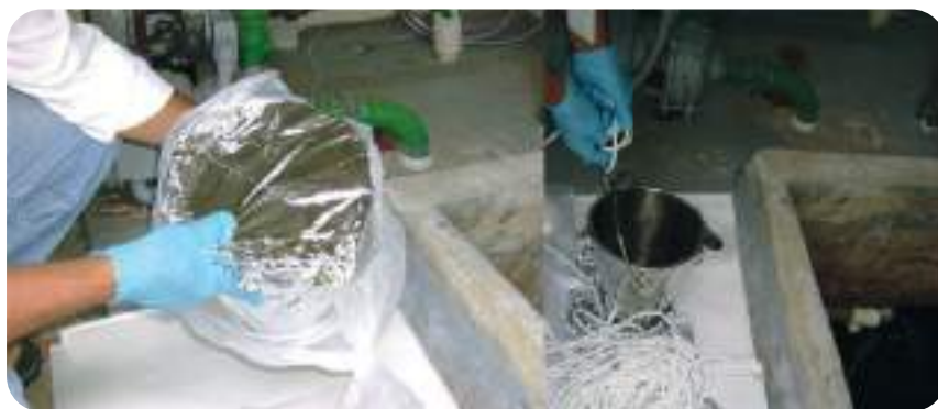
Figura 7.5. Toma de muestras en embalse con balde y cuerda estériles: (A) Balde estéril, (B) Balde y cuerda estéril en procedimiento de muestreo.
