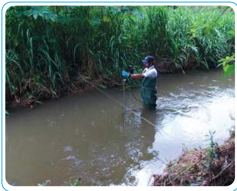
Figura 9.4. Medición de caudal a vado con un medidor ultrasónico.
