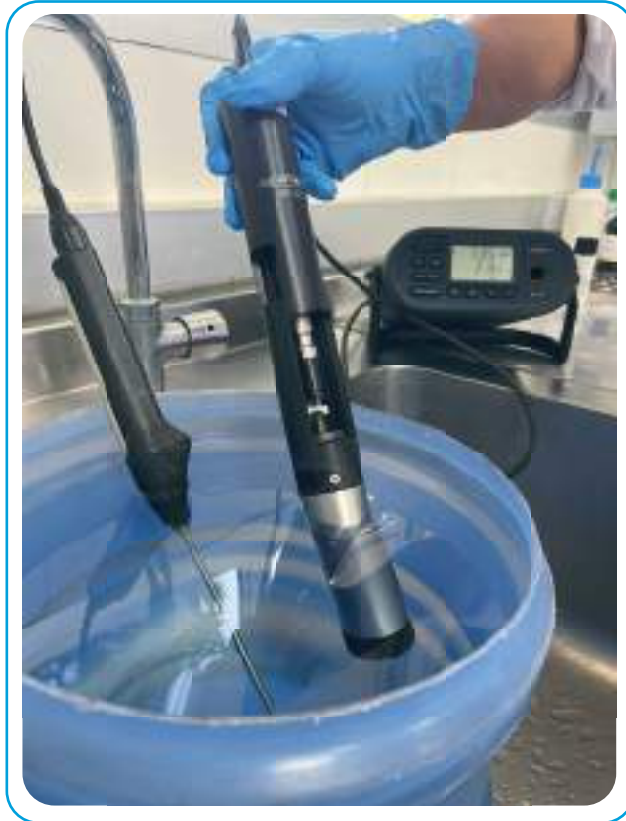
Figura 8.2. Verificación del sistema de medición de OD (electrodo de membrana con sistema de agitación) en agua saturada.
