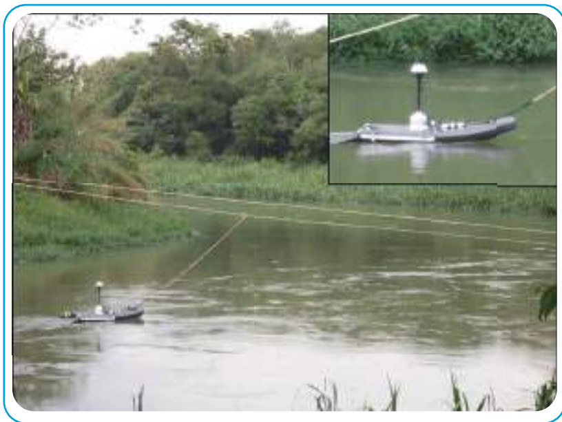
Figura 9.5. Medición de caudal con perfilador de corriente acústico Doppler (ADCP) acoplado a un pequeño catamarán.
