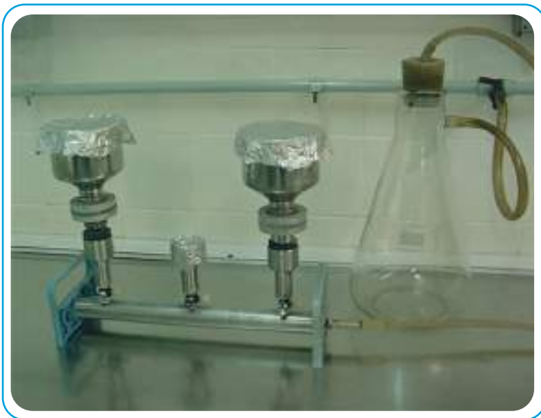
Figura 6.13. Sistema portafiltros para filtrar muestras para ensayo de Clorofila a y Feofitina a en el laboratorio.
