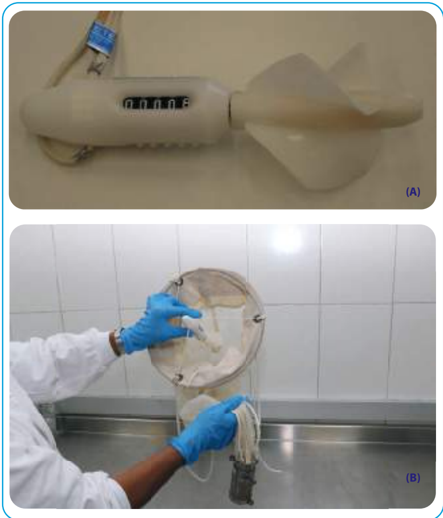
Figura 5.13. Caudalímetro: (A) Caudalímetro resaltado; (B) Caudalímetro acoplado a red de plancton
