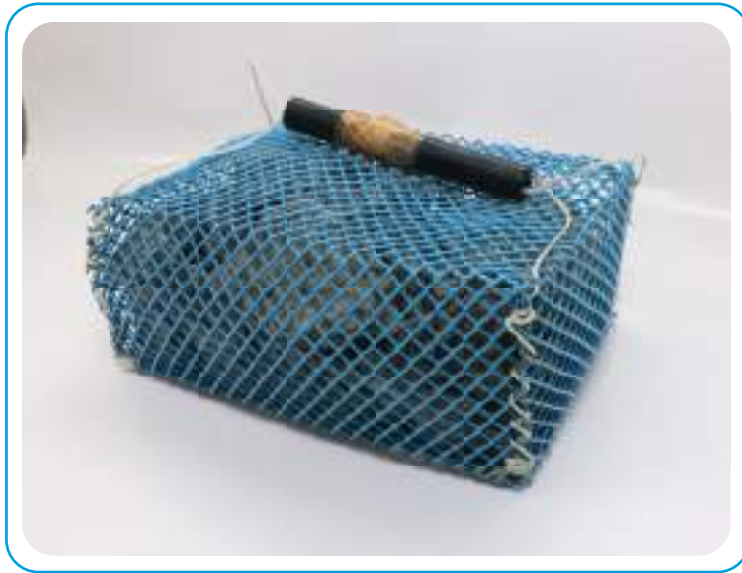
Figura 5.31. Sustrato artificial tipo cesta llena de piedras trituradas.
