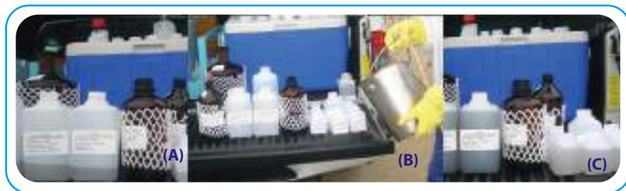
Figura 6.2. Toma de muestras de agua superficial: (A) Disposición de frascos con identificación; (B) Distribución de la muestra en todos los frascos; (C) Frascos llenos de muestras.
