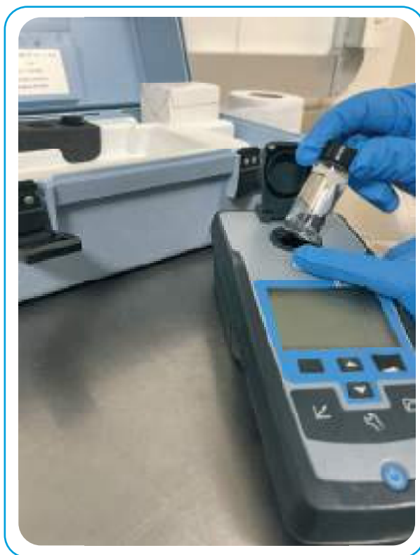
Figura 8.6. Determinación de la turbidez en el agua tratada, inserción de la celda en el equipo.
