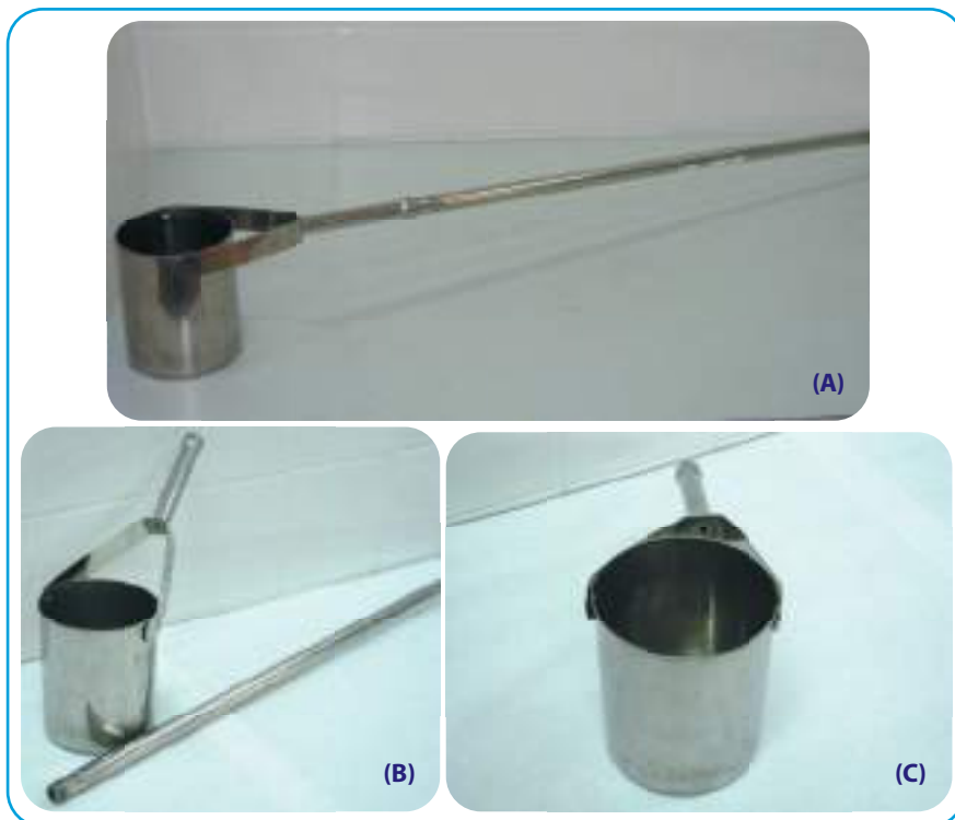
Figura 5.2. Recolector con brazo atornillable: (A) Vista lateral del equipo montado; (B) Vista del recolector y del brazo atornillable desmontado; (C) Vista superior del recolector.
