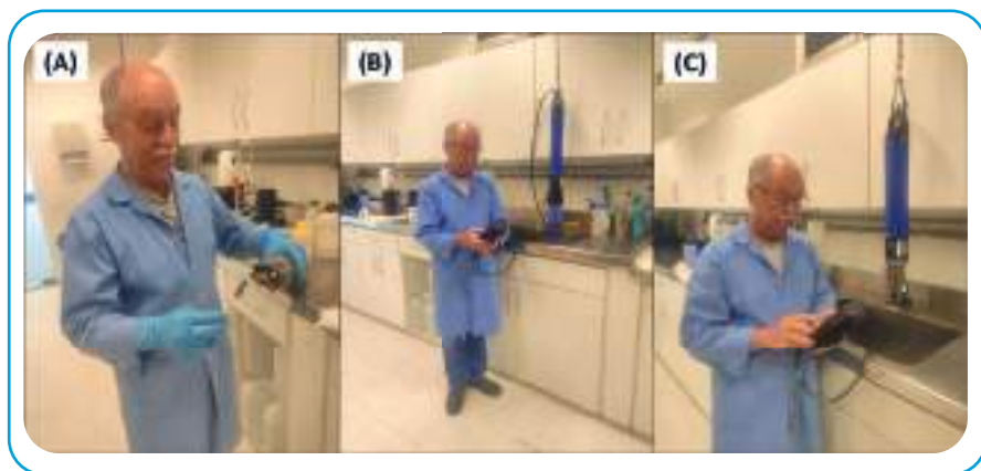
Figura 8.10 - Mantenimiento de la sonda multiparámetro: (A, B y C) limpieza y calibración de los sensores de oxígeno disuelto, pH y conductividad eléctrica
