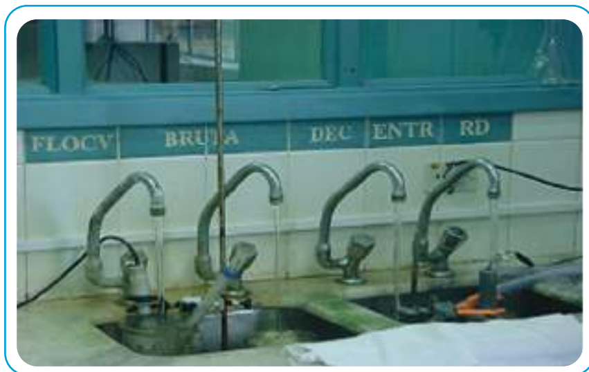
Figura 7.2. Grifos localizados en el laboratorio de una ETA para el control de las etapas del proceso de tratamiento.
