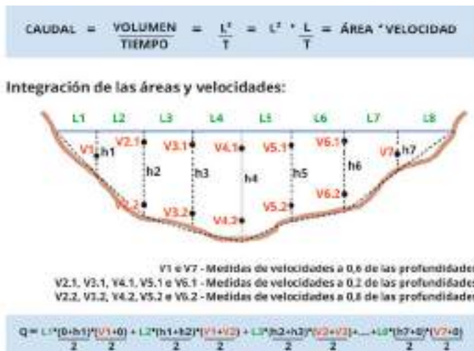
Figura 9.2. Cálculo de caudal mediante el método Área-Velocidad.
