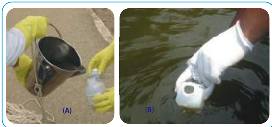
Figura 6.8. Toma de muestras de aguas superficiales para análisis microbiológicos: (A) Con balde de acero inoxidable; (B) Directamente del cuerpo de agua.
