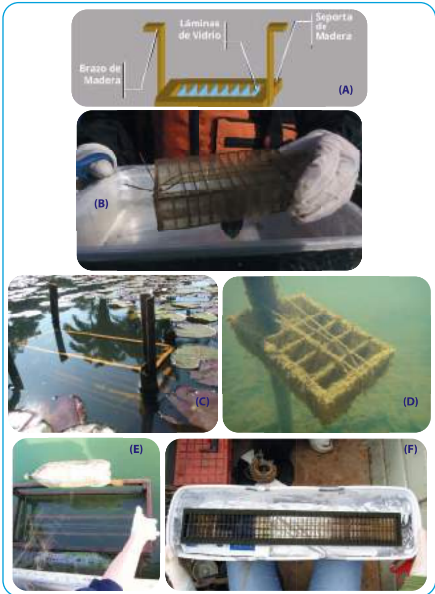
Figura 5.32. Soportes con láminas: (A) Esquema que muestra un soporte para láminas de vidrio; (B) Soporte acrílico que contiene láminas de vidrio colonizado; (C) Estructura fija que contiene soporte de madera con láminas de vidrio para colonización; (D) Sustrato de acrílico sumergido con 35 días de colonización fijado en un tubo de PVC; (E) Estructura de madera con flotadores con láminas de vidrio para colonización; (F) Soporte de madera con láminas de vidrio colonizadas.
