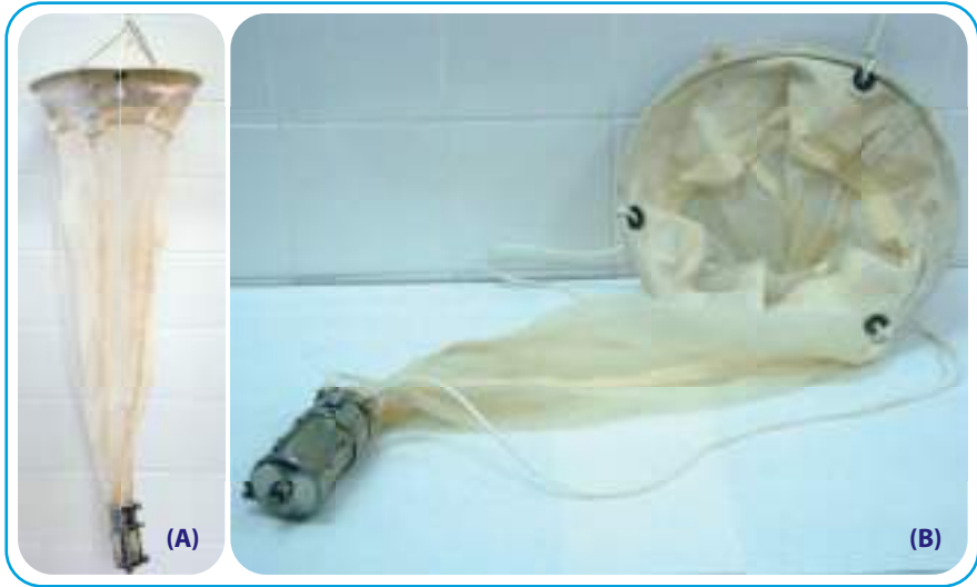
Figura 5.11. Red de plancton: (A) Vista frontal de la red y el vaso recolector; (B) Vista lateral de la red y el vaso recolector.
