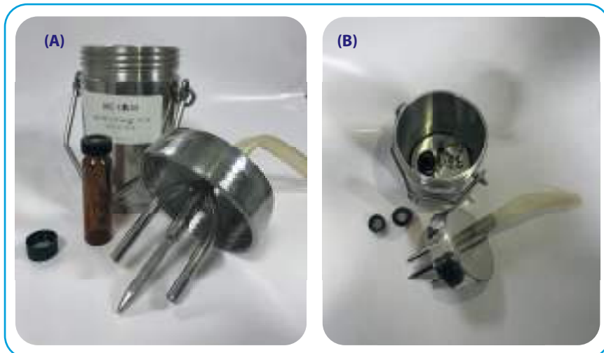
Figura 5.4. Batiscafo para la determinación de compuestos orgánicos volátiles: (A) Vista frontal del Batiscafo abierto; (B) Vista superior del Batiscafo abierto con frasco tipo Vial posicionado.
